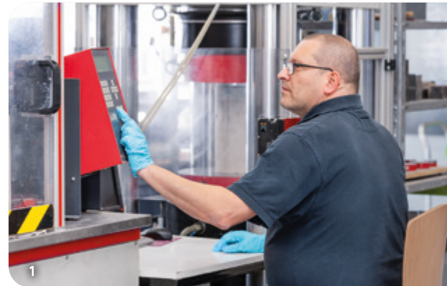
Abb. 1: Mitarbeiter des IMB/MPA/CMM bei der Prüfung von Betonprobekörpern © KIT IMB/MPA/CMM
